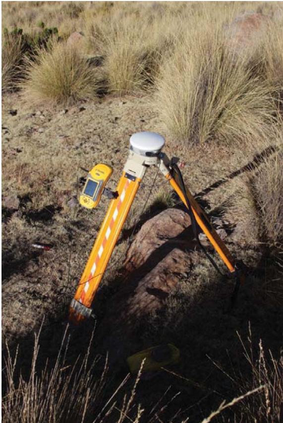
Figura 7. Registro del datum maestro con Trimble Geoexplorer XT.
